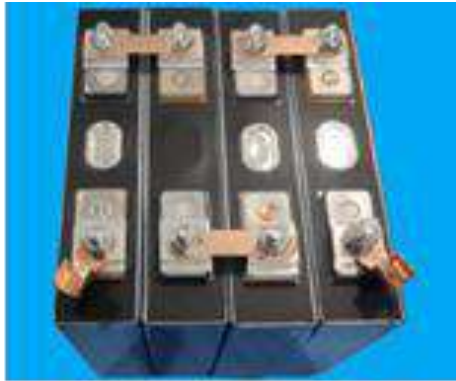
รูปที่ 2.4 Battery Lifepo4 ความจุ20A 12V+BMS
