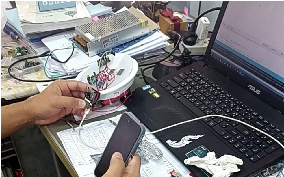
ภาพที่ 3.10 การเขียนโปรแกรมและอัปโหลดโค้ดโปรแกรมลงบอร์ด Arduino Nano 3.0 Mini และ ESP32 CAM
